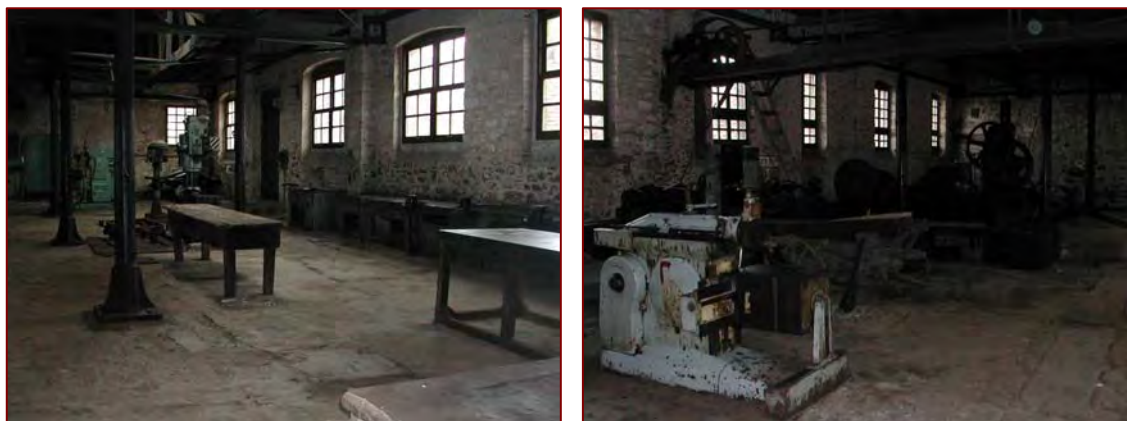
Εικόνες 4.37-38. το εσωτερικό του Μηχανουργείου. Διακρίνονται οι μάντες μετάδοσης κίνησης στην οροφή που αργότερα αντικαταστάθηκαν από ηλεκτροκινητήρες. (Φωτογραφίες: Τσόλης Ευστάθιος, Δεκέμβριος 2002).
