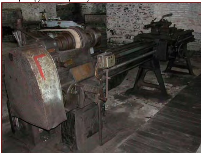
Εικόνα 2.7. Άποψη τόννου από το μηχανουργείο της Γαλλικής Εταιρίας Μεταλλείων Λαυρίου. Οι κυριότερες μετατροπές που έχει δεχτεί αφορούν την προσθήκη ηλεκτροκινητήρα, αντί της αρχικής κίνησης μέσω κεντρικού κινητήρα που διέδιδε την κίνηση με μιάντα. (Φωτογράφιση: Τσόλης Ευστάθιος, Δεκέμβριος 2002)
